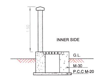
TYPICAL SECTION OF S.W. DRAIN LINE/ COMPOUND WALL
